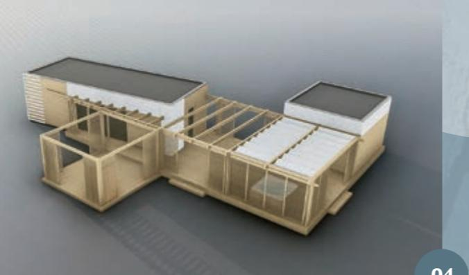
Kompozitna konstrukcija sa umreženim drvenim pločama, multifunkcijske mogućnosti dodatnih modula, mobilna sauna, mobilni fitnes, mobilna jedinica sa jaccuzijem, mobilni prostor za druženje ...
